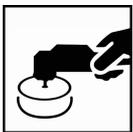
Тщательная полировка зоны перехода с полировочной пастой содержащий абразив с использованием полировальной машинки.
